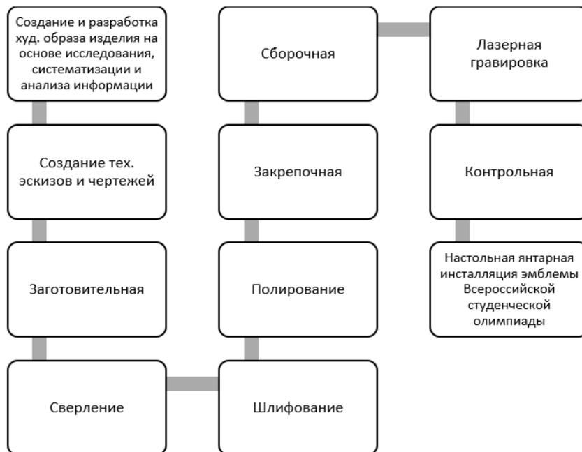
Рисунок В.32 — Функциональная схема технологического процесса изготовления настольной янтарной инсталляции эмблемы Всероссийской студенческой олимпиады
