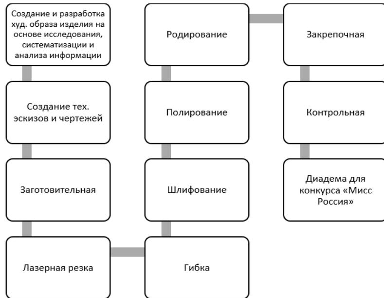
Рисунок В.31 — Функциональная схема технологического процесса изготовления диадемы для конкурса красоты «Мисс Россия»
