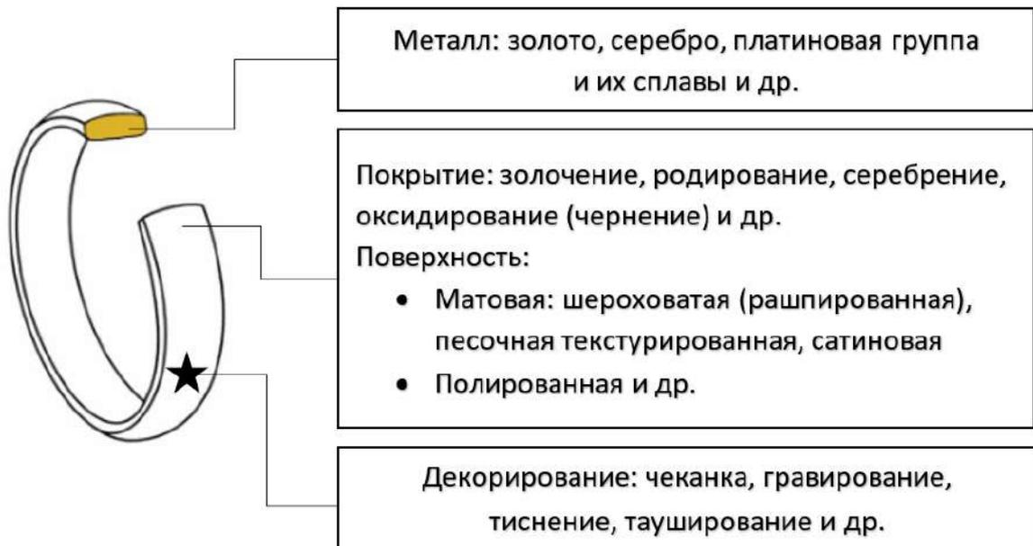
Рисунок А.20 – Многослойная структура ювелирных изделий с механической точки зрения
